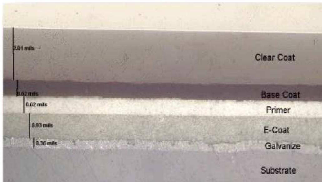
**Figura 6:** Camadas de revestimento utilizadas em chapas de automóveis. (RAMOS et. al, 2008)
