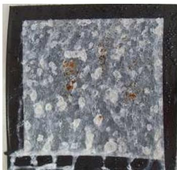
**Figura 15:** CP com 130 horas de exposição com elevada quantidade de produtos de corrosão.
