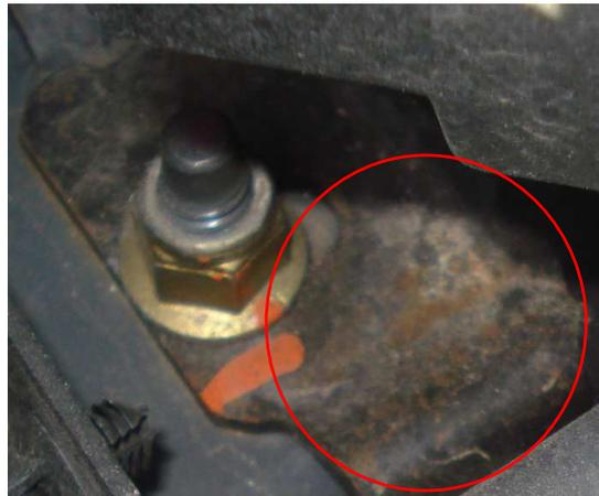
**Figura 17:** Chapa de aço pintada na região do motor com um ano de uso.
