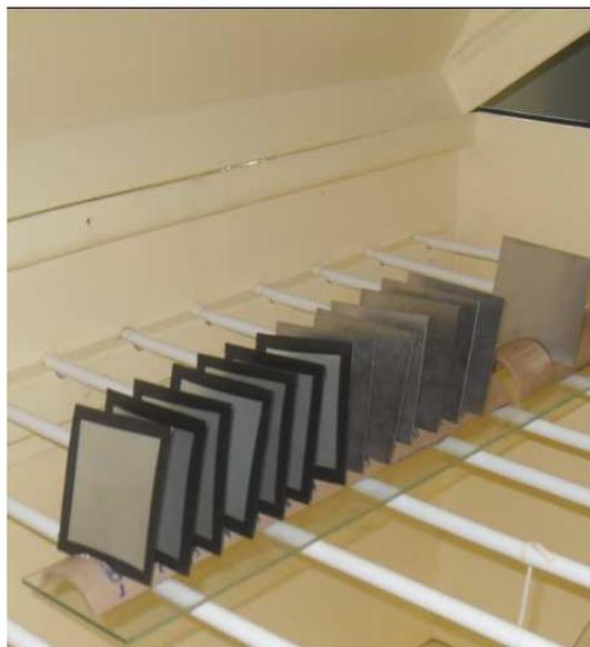
**Figura 10:** Disposição dos corpos de prova na câmara de corrosão.
