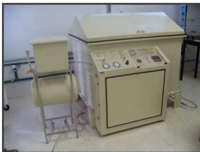
**Figura 12:** Cabine de corrosão utilizada no ensaio.
