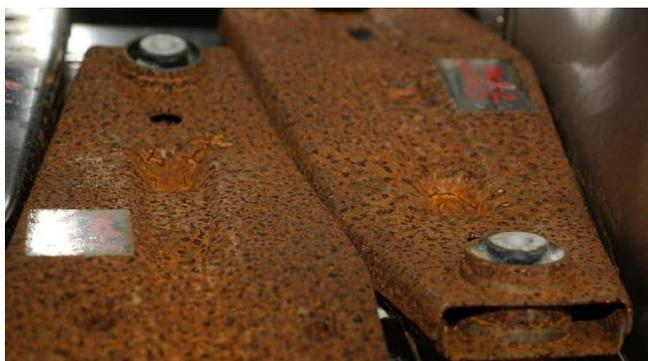
**Figura 18:** Corpo de prova de aço não galvanizado submetido a ensaio cíclico (8 ciclos).
