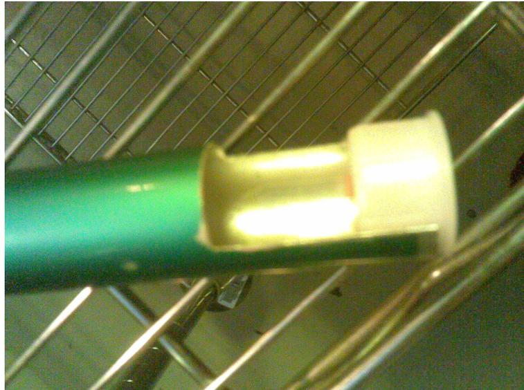
**Figura 4.** Engrenagem de fixação no OPC
