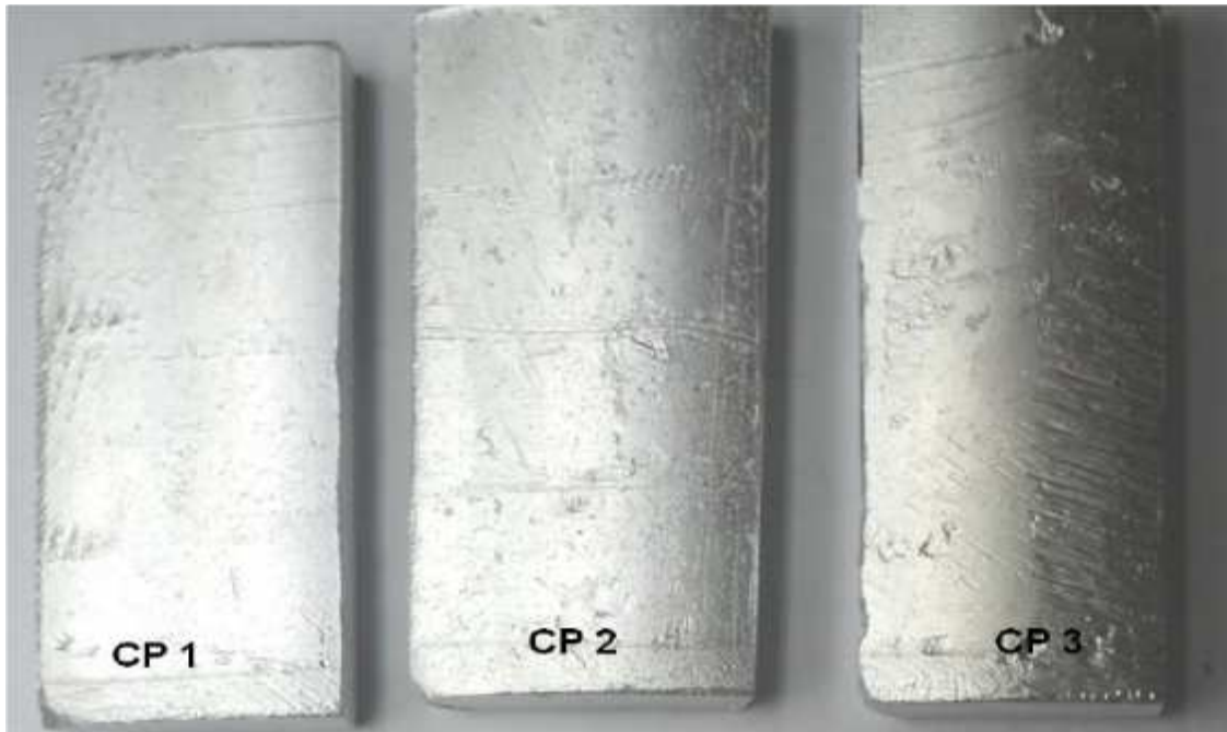
Figura 19 – Aspecto macroscópico das amostras sem solda, antes do ensaio. Fonte: Do autor
