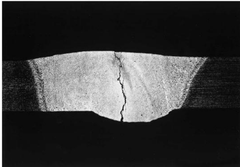
Figura 10 – Trinca de solidificação em solda de alumínio. Fonte: Mathers (2002)
