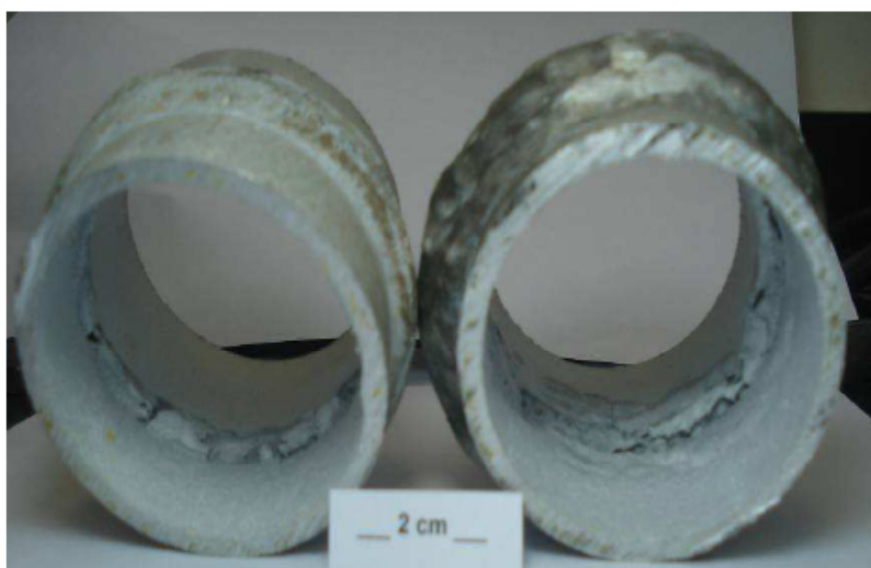
Figura 2 – Tubos de alumínio 3003 com perda de espessura localizada no cordão de solda e ZTA. Fonte: Do autor
