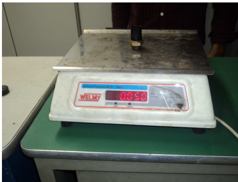
Figura 37 – Pesagem do Sensor de temperatura para ativação do eletro ventilador
