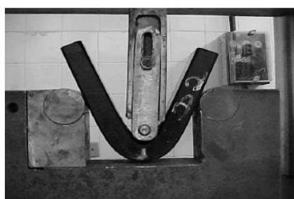
16b) Ensaio de dobramento
