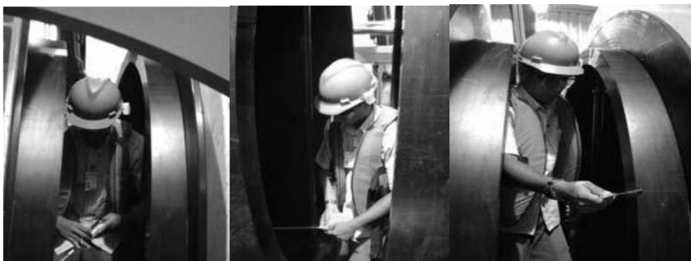
Figura 12 – Inspeção dimensional e linearidade das faces a serem soldadas
