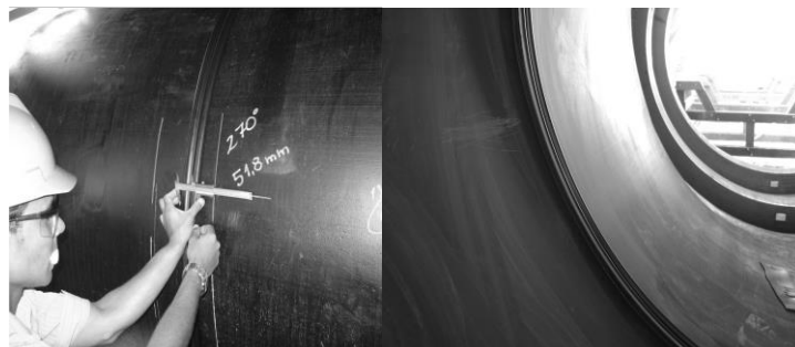
Figura 15 – Inspeção visual e dimensional do cordão de solda
