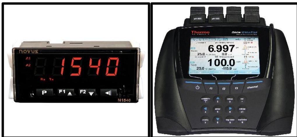
Figura 28 - Novus N1540 à esquerda, Orion Versa Star Pro à direita (Fonte: Próprio Autor)
