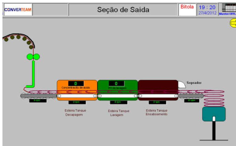
Figura 22 - Tela gráfica das esteiras dos tanques de decapagem, lavagem e ensaboamento.
