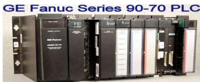
Figura 7-Cartão de saída analógico instalado sobre o *backplane* do CLP. Fonte: Própria
