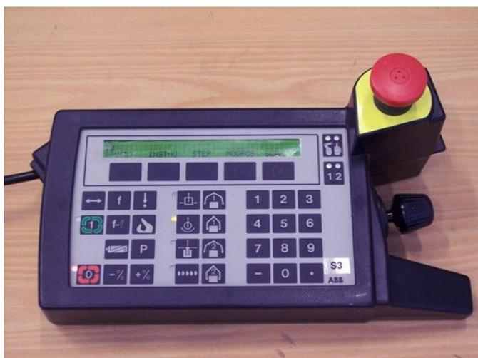
**Figura 3 – Dispositivo de programação para robô ABB**
