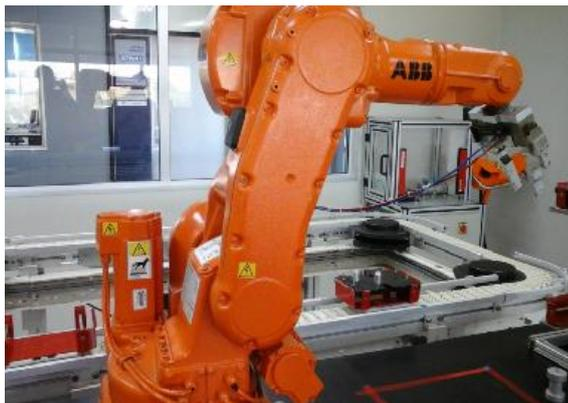
**Figura 23 - Robô ABB IRB 140**
