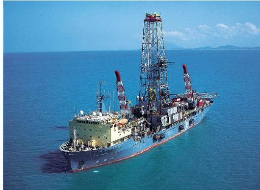
**Figura 7 – Exemplo de navio sonda.**
