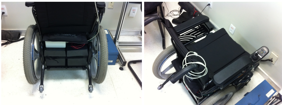
Figura 29 – Implementação da Caixa com o circuito de controle na cadeira de rodas e a aparência final vista pelo usuário. Fonte: Autor.
