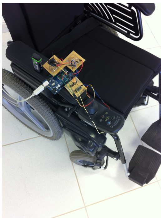
Figura 28 – Placas de circuito impresso conectadas ao Arduino junto à cadeira de rodas. Fonte: Autor.
