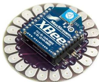
Figura 5.5. XBee Lilypad. Fonte:Multilógica Shop (2014).
