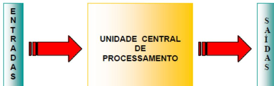
Figura 3 - Estrutura Básica de um CLP
