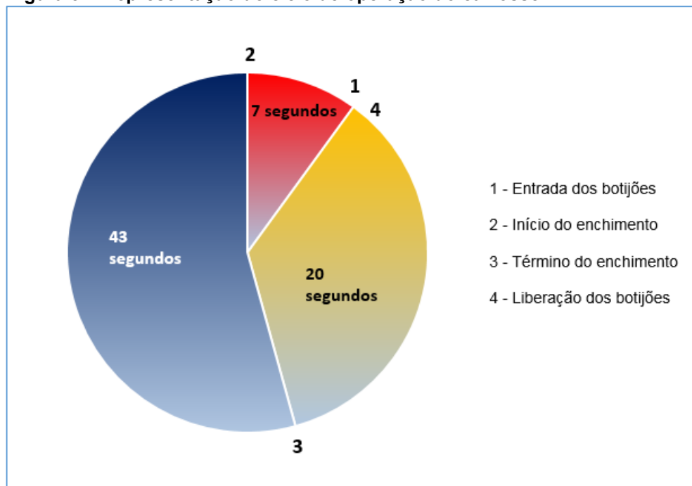
Figura 5 – Representação do ciclo de operação do carrossel
