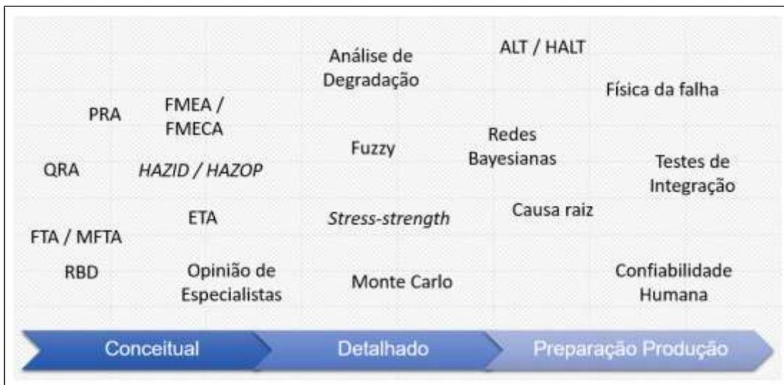
Figura 11 Confiabilidade aplicada ao PDP.
