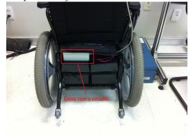
Figura 3.17: Implementação da caixa com o circuito de controle.
