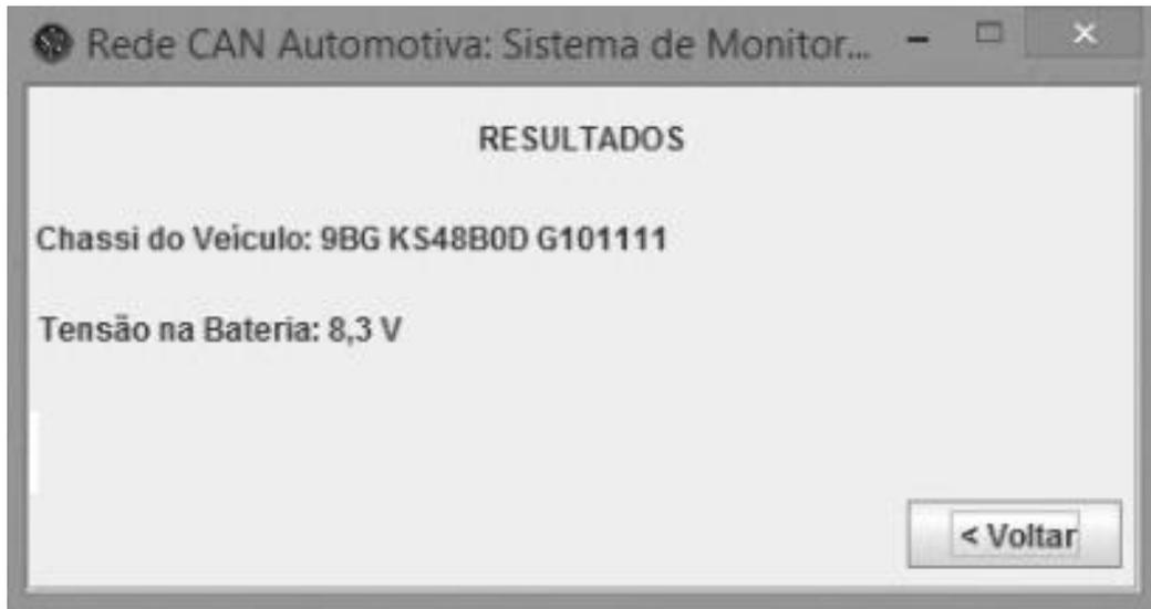
Figura 4.31 – Parâmetro “Tensão da bateria” sendo mostrado com valor diferente do real, em uma simulação se carga baixa da Bateria. Fonte: Autor
