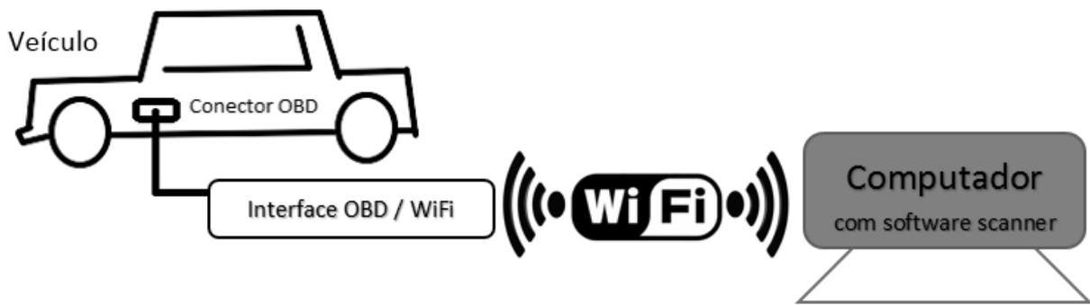
Figura 4.17 – Aspecto do funcionamento do modelo. Fonte: Autor.
