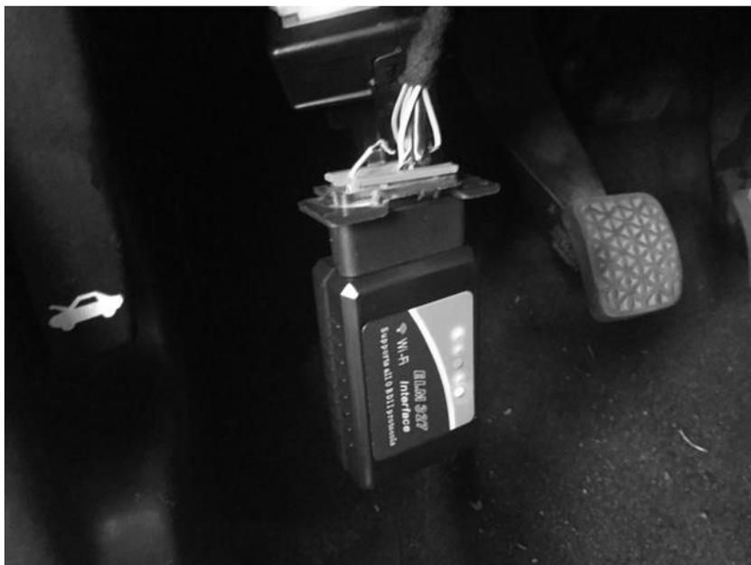
Figura 3.2 – Interface *WiFi* OBD conectada ao veículo de teste. Fonte: Autor
