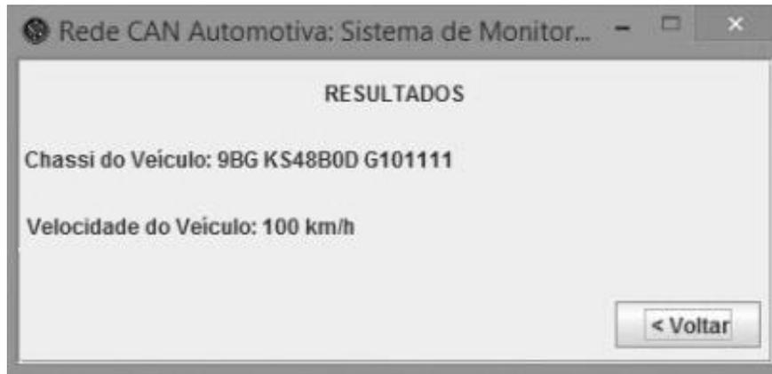
Figura 4.35 – Perfil do aluno mostrando veículo a 100 km/h, sendo que o mesmo se encontra parado no laboratório. Fonte: Autor
