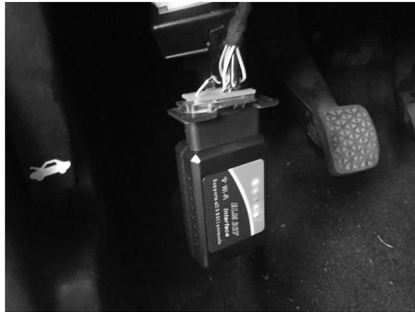
Figura C3 – Interface OBD/WiFi conectada ao conector OBD do veículo
