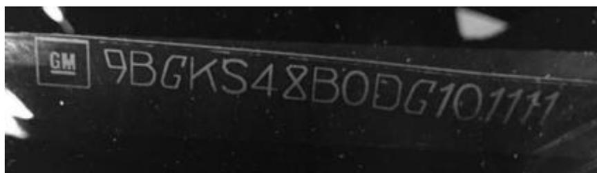
Figura 3.4 – Numeração VIN em baixo relevo do Chevrolet Onix testado. Fonte: Autor.
