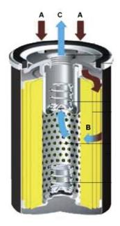
Figura 11 – Representação em corte de um filtro com elemento filtrante.
