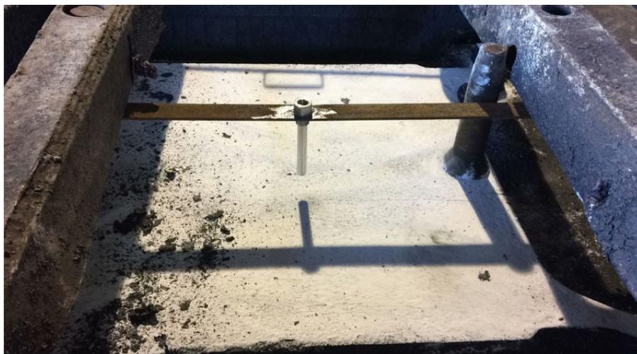
A Figura 16 apresenta o transmissor de temperatura instalado na Roda de Moldagem em destaque.
