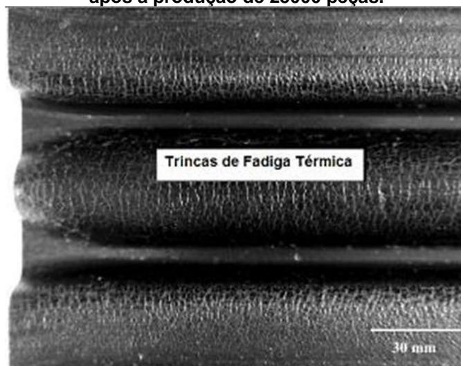
Superfície revestida por soldagem com multicamadas e nitretada.
