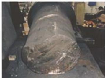
**b) Haste de pistão fraturado por causa da operação a frio e desalinhamento.**
