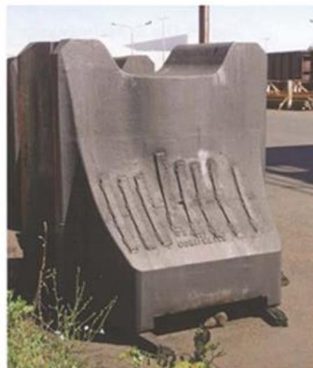
**c) Massa superior de um Martelo de contragolpe fraturada e mantida com talas para remoção e eventual reparo.**
