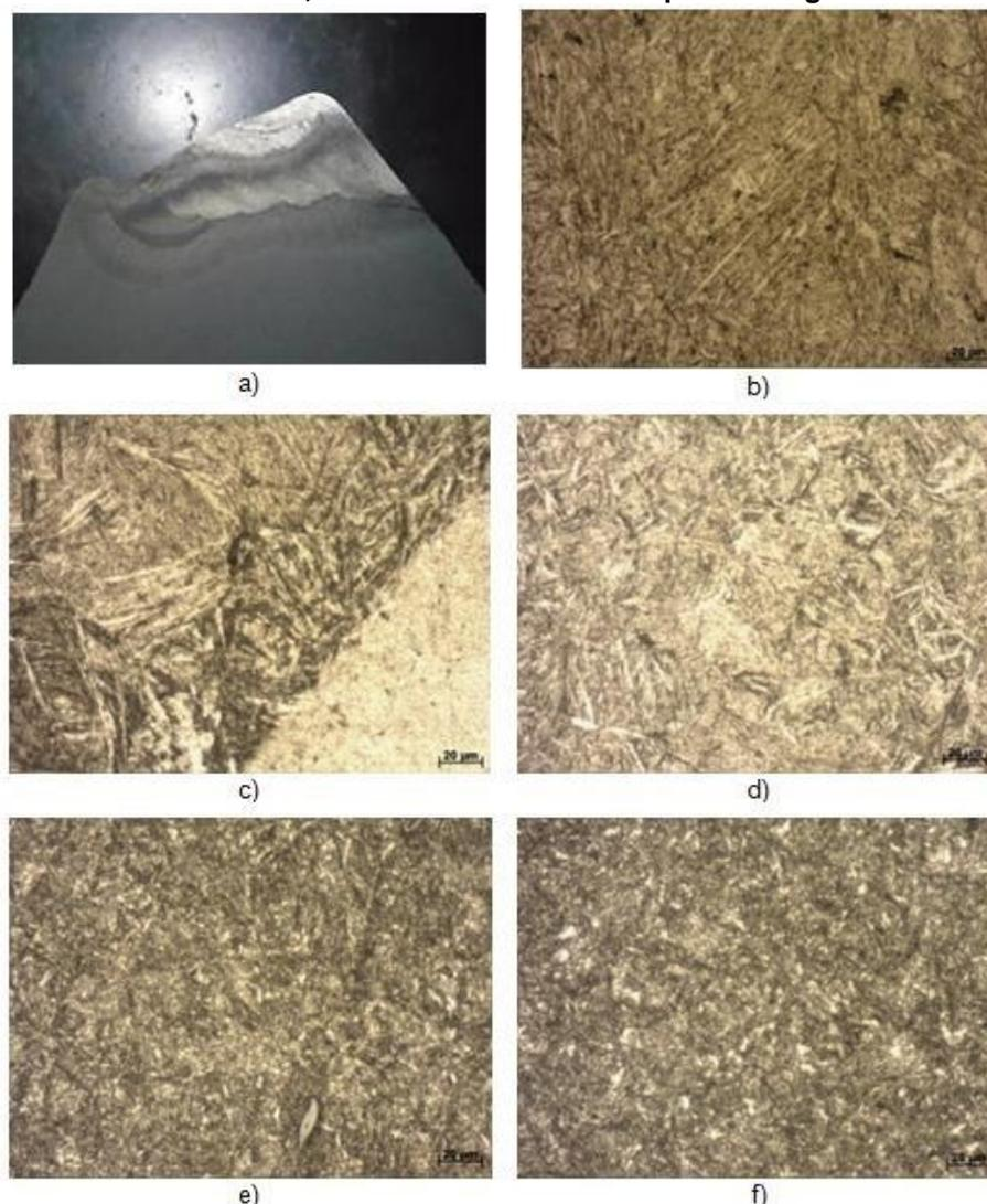
**a) Macro da região soldada, persulfato de amônio a 20% por 6h; b) Metal de solda – MS a 500x, Nital 3% c) Zona Fundida – ZF, Zona Parcialmente Fundida – ZPF e Zona de Grãos Grosseiros – ZGG a 500x, Nital 3% d) Zona de Recristalização de Grãos – ZRG, 500x, Nital 3%; e) Zona Parcialmente Transformada – ZPT e Zona Revenida – ZR, 500x, Nital 3%; f) Metal de Base – MB, 500x, Nital 3%. Processo SMAW e consumível DIN 8555 E3-UM-40PT.**
