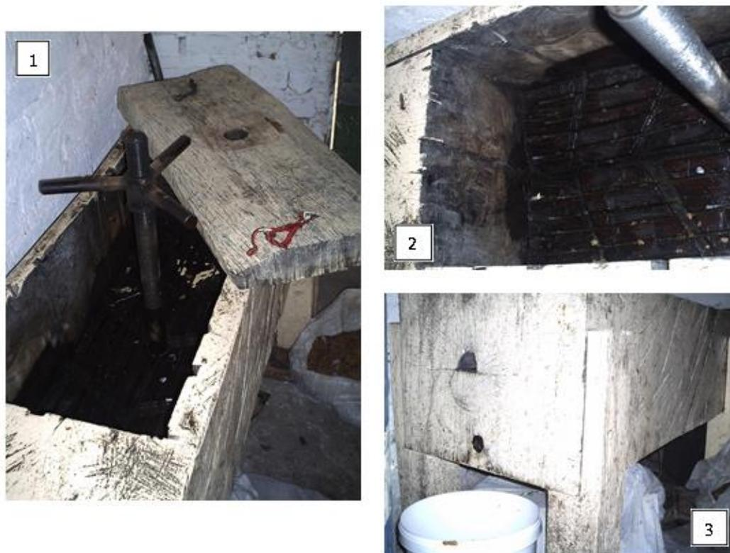
(1) prensa; (2) ranhuras da parte interna que conduz à perfuração por onde escorre o líquido extraído; (3) parte externa da prensa com perfuração para coleta do líquido.
