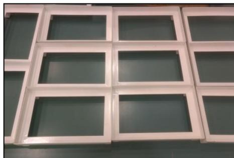
**Figura 14: Suportes metálicos que foram comprados para organizar e selecionar as perdas geradas durante o processo.**
